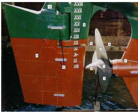
1.- Núcleo de la hélice, 2.- Cara activa de la pala, 3.- Cara inactiva de la pala, 4.- Ancha de entrada, 5.- Ancha de salida, 6.- Tapón de la fuerza, 7.- Codaste de la hélice, 8.- Codaste del timón, 9.- Timón, 10.- Anillos anticorrosivos
